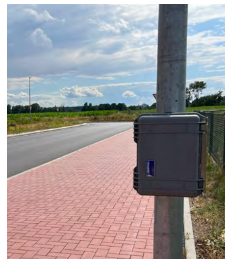
Abb. 1-4 Seitenradargerät zur Verkehrserfassung
